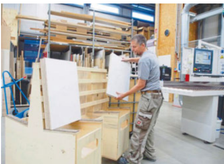
/ Pffiffig: Diesen durchdachten Transportwagen hat das Gießelbach-Team entwickelt und vielfach im Einsatz.
