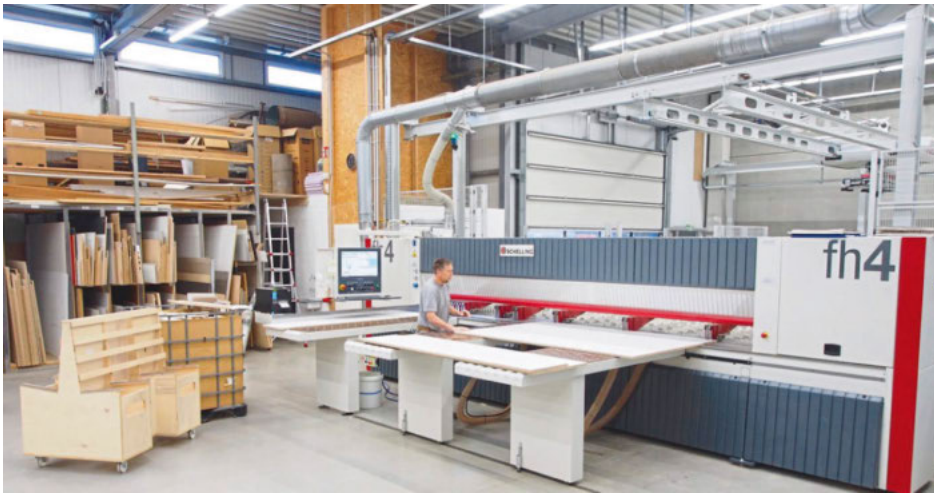
/ Auf hohen Durchsatz und maximale Präzision ausgelegt: Die Plattenaufteilsäge Schelling fh 4 wird auch für Paketschnitte und zum Nuten eingesetzt. Beschickt wird sie aus dem vollautomatischen Plattenlager ...
