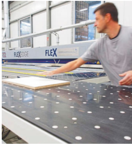
/ Luftkissentische sorgen für einfaches und oberflächenschonendes Teilehandling.
