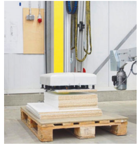
/ Die fertig bekanteten Möbelteile werden automatisch auf Paletten abgestapelt.
