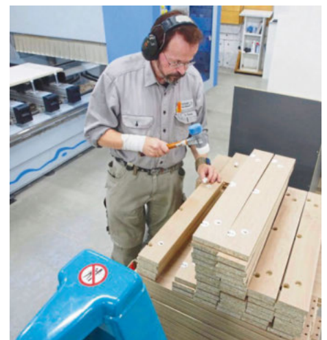
/ Während die CNC bohrt und fräht, versieht der Maschinenbediener die Teile mit Beschlägen.
