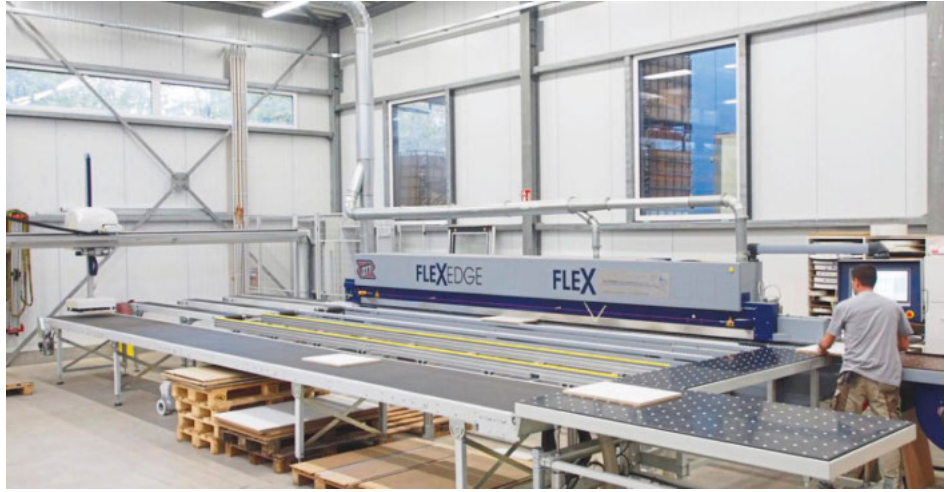
/ Hochflexible Kantenbearbeitung: Die FlexEdge von Ott überzeugt als leistungsstarker Allrounder. Die Teilerückführung und automatische Abstapelung (Barbaric) ermöglichen rationellen Ein-Mann-Betrieb.
