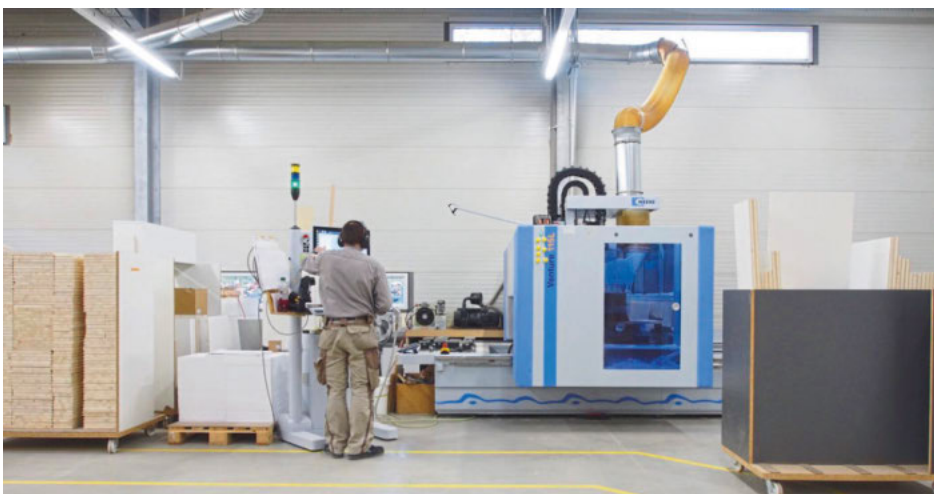
/ Das 5-Achs-CNC-Bearbeitungszentrum Homag Venture 115 ist aktuell das Nadelöhr in der Produktion. Lläuft die Maschine in zwei Schichten, liegt die Kapazität der Hightech-Tischlerei bei 500 bis 600 Teilen pro Tag.
